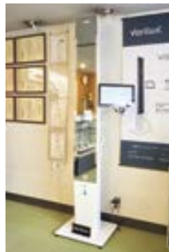
昨年導入した最新式の測定器。眼球の長さや頭部の傾き、視線の動きなどのパーソナルデータを測定し、より快適に見えるレンズを作製する。
