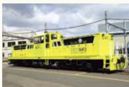
リチウムイオンバッテリーを搭載し、モーターで駆動する最新鋭牽引車を開発。SDGs、脱炭素社会に貢献する新車両として期待されている。
